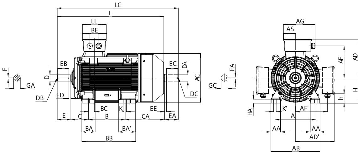
IM B35 安装结构型式 Type of construction IM B35
