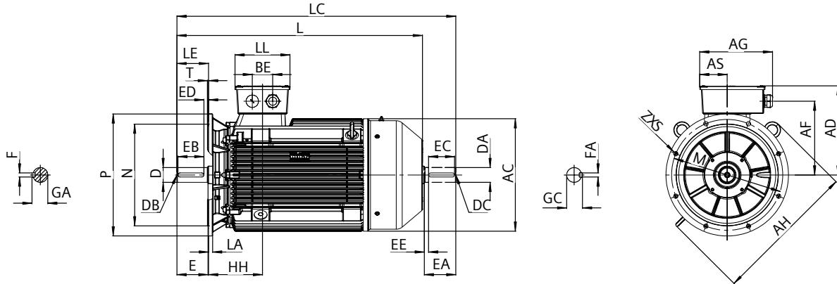
IM B14 安装方式 Type of construction IM B14
