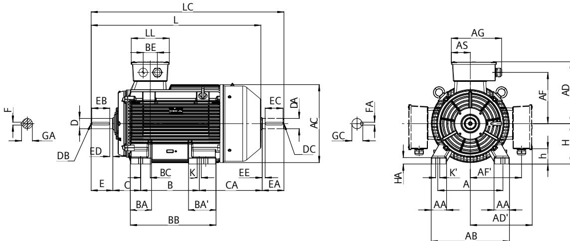
IM B35 安装结构方式 Type of construction IM B35
