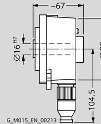
HOG9 D 1024 LL 转脉冲编码器的安装尺寸
