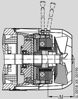
**图 2 用于各种结构型式标准防雨罩**
