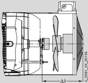
图 8 制动器、旋转脉冲编码器 (在风扇罩内) 和独立驱动风扇
