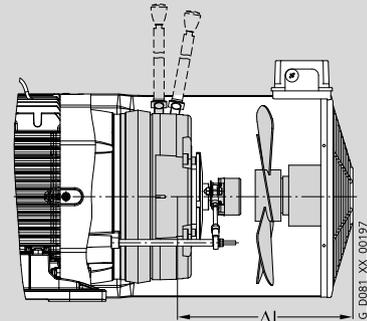
图 9 独立驱动风扇的防雨罩
