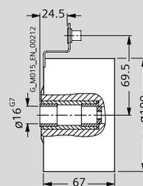
旋转脉冲编码器 LL 861 900 220 的安装尺寸
