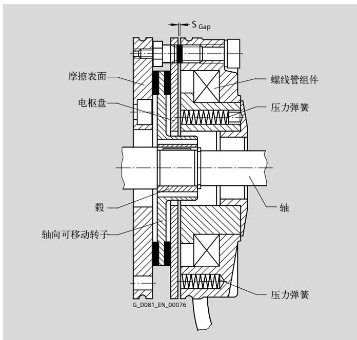
2LM8 弹簧操作盘式制动器的设计
