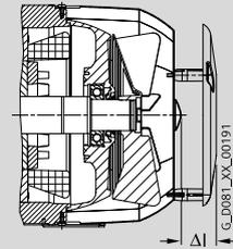
**图 3 旋转脉冲编码器 (在风扇罩外)**
