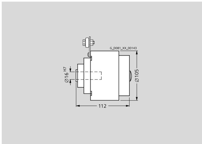
HOG10 D 1024 I 型旋转脉冲编码器的安装尺寸
